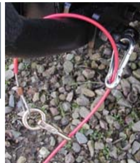
Let er bij de aankoop van deze D-sluiting, harpsluiting of karabijnhaak op dat deze hulpmiddelen breekwaarden hebben die de waarden van de breekhaak of breekkring overstijgen. Deze hulpmiddelen kunnen vastgemaakt worden aan/in de ogen en ovale gaten waarna de losbreekremkabel er doorheen gelust kan worden (zie rechterfoto).
