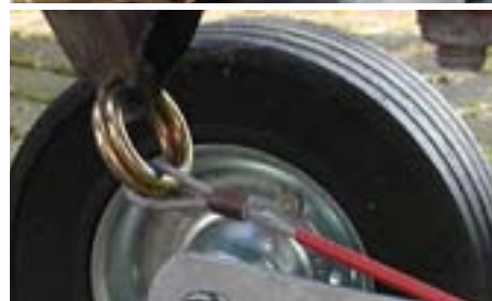
De breekhaak of breekring van ALKO (veelal rode bemanteling) heeft een breekwaarde van tenminste 3500 N (+ 900) voor de breekhaak en 3500 N (+ 500) voor de breekring. De dikte van de breekhaak bedraagt 7 millimeter en 5 millimeter voor de breekring.
