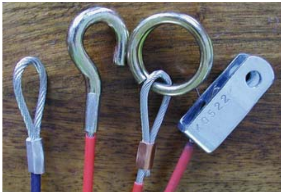
Helaas komen er in het marktsegment van aanhangwagens en caravans ook imitatie losbreekremkabels voor. Deze zijn niet alleen goedkoper, maar de werking laat te wensen over. Vaak is de draaddikte van de breekkring dunner en van inferieure kwaliteit.
