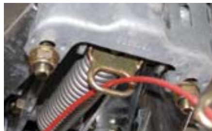
Het is belangrijk dat de breekkabel altijd via een geleiding (met weinig wrijving) in rechte lijn naar de trekhaak loopt. Is dit niet zo, dan bestaat de kans dat de handrem van opzij wordt aangetrokken waardoor geen of onvoldoende werkzame kracht wordt overgebracht op het remsysteem.
