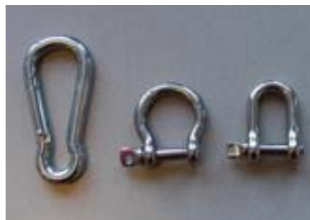
Let er bij de aankoop van deze D-sluiting, harpsluiting of karabijnhaak op dat deze hulpmiddelen breekwaarden hebben die de waarden van de breekhaak of breekkring overstijgen. Deze hulpmiddelen kunnen vastgemaakt worden aan/in de ogen en ovale gaten waarna de losbreekremkabel er doorheen gelust kan worden (zie rechterfoto).
