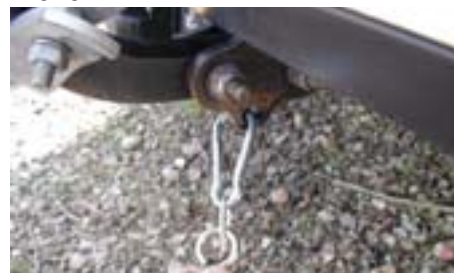
Als de hulpmiddelen aantoonbaar (opschrift) voldoende sterk zijn, kan de staalkabel rechtstreeks aan dit hulpmiddel worden bevestigd. De musketonhaak heeft dan geen functie meer.
